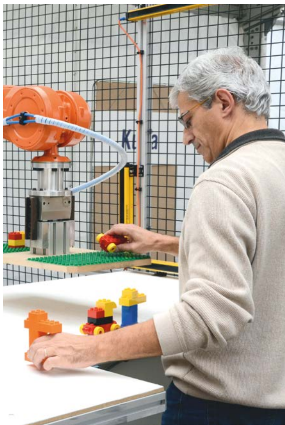
Avec les robots collaboratifs (ici un modèle ABB), l'homme peut partager sans crainte son espace de travail avec la machine.
