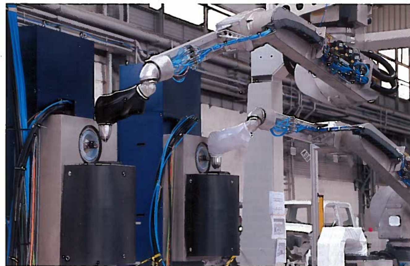
Station peinture SAMES, sur plateforme chantier au sein de l'entreprise meylanaise.
