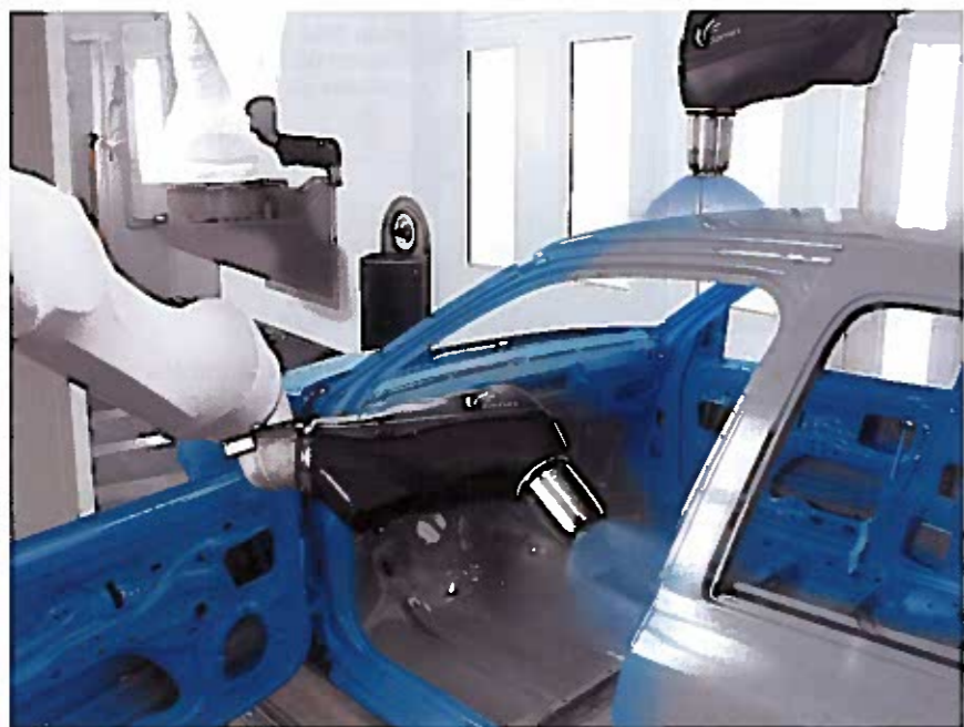
Pulvérisateur Accubell 709 monté sur robot multiaxes.
